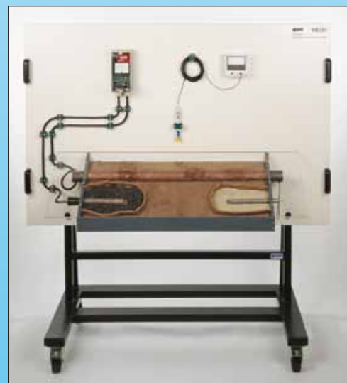
VS 121 Démonstration protection cathodique contre la corrosion
