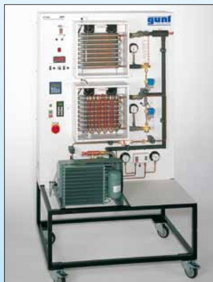
ET 426 Régulation de puissance sur les installations frigorifique
