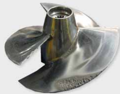
Durch Kavitationserosion zerstörter Schiffpropeller
