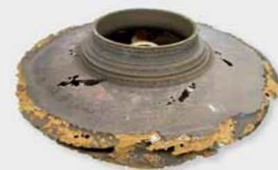
Durch Kavitationserosion zerstörtes Pumpenlaufrad
