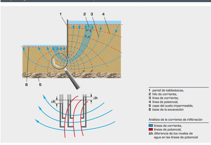
Las corrientes de infiltración no se pueden observar directamente porque se encuentran en medios porosos no visibles. Todos estos procesos solo pueden "visualizarse" en modelos de laboratorio o en instrumentos de medición correspondientes.
