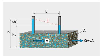
h<sub>1</sub>, h<sub>2</sub> niveles de agua, L longitud atravesada por el flujo, i gradiente hidráulico, v velocidad de filtración, Q caudal, A superficie de sección transversal atravesada por el flujo
