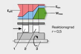
Überdruck- oder Reaktionsturbine: Die Umwandlung der potentiellen Druckenergie wird auf Leitapparat und Laufrad aufgeteilt. Die kinetische Energie wird dann im Laufrad in mechanische Arbeit
