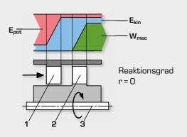
Gleichdruck- oder Aktionsturbine: Potentielle Druckenergie wird im Leitapparat vollständig in kinetische Energie umgewandelt. Diese wird im Laufrad in mechanische Arbeit umgesetzt.
