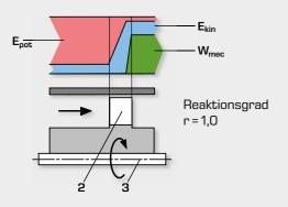
Reine Reaktionsturbine: Die Umwandlung der potentiellen Druckenergie in kinetische Energie findet nur in einer Düse im Laufrad statt. Der Rückstoß der Düse liefert dann den Impuls für die mechanische Arbeit. Industriell wird die reine Reaktionsturbine nicht genutzt. Die Abbildung zeigt eine abstrahierte Form.
