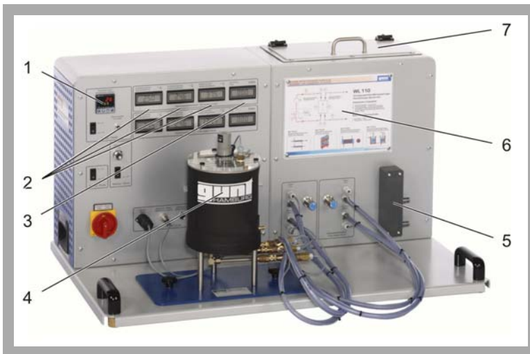
1 Temperaturregler, 2 Temperaturanzeigen, 3 Durchflussanzeigen, 4 Doppelmantel-Wärmeübertrager WL 110.04, 5 Anschlüsse für Kaltwasserkreislauf, 6 Prozessschema, 7 Behälter für Warmwasser
