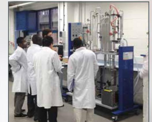
Ein Mitarbeiter von GUNT erläutert Dozenten von der University of Hull die Funktionsweise der Gasabsorption CE 400.
