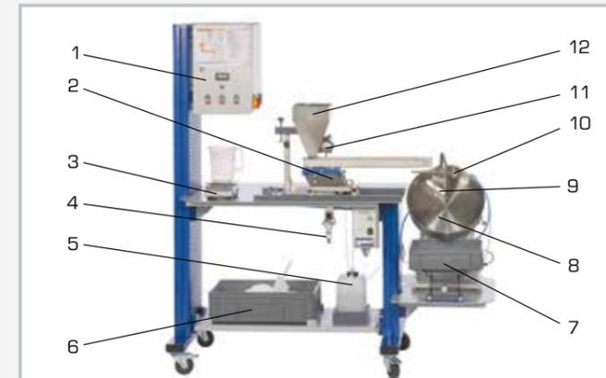
1 Schaltschrank, 2 Feststoff-Dosiereinrichtung, 3 Waage, 4 Druckminderventil, 5 Behälter Granulierflüssigkeit, 6 Behälter Feststoff, 7 Behälter Agglomerate, 8 Granulierteller, 9 Schaber, 10 Zweistoffdüse, 11 Vibrator, 12 Silo Feststoff
