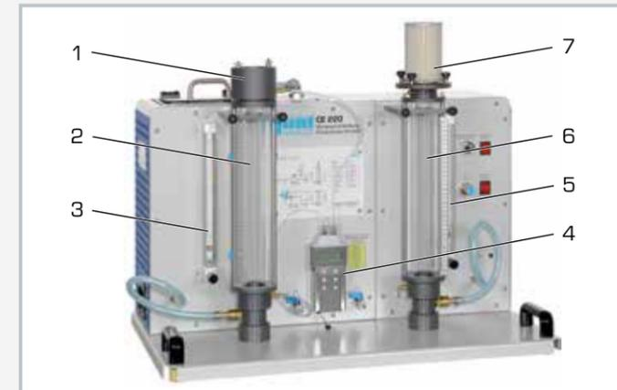
1 Wasserüberlauf, 2 Behälter für Wasser, 3 Schwebekörper-Durchflussmesser für Wasser, 4 Handmessgerät Druckverlust, 5 Schwebekörper-Durchflussmesser für Luft, 6 Behälter für Luft, 7 Filter
