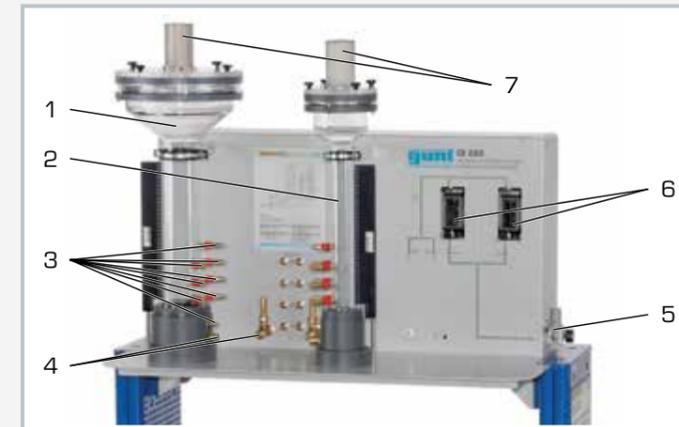
1 Kolonne K1 mit Ø 100mm, 2 Kolonne K2 mit Ø 50mm, 3 Differenzdruckmesspunkte von K1, 4 Gasversorgung von K1, 5 Gasversorgung des Versuchsstands, 6 Durchflussmessung für 2 Messbereiche
