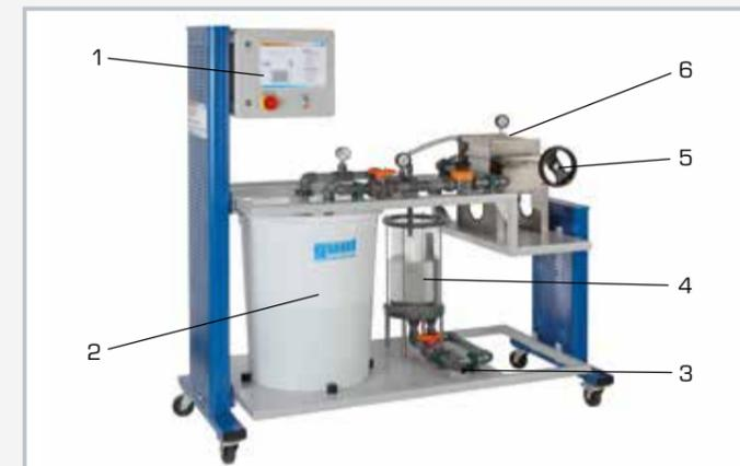
1 Schaltkasten mit Bedienelementen, 2 Behälter Suspension, 3 Ablauf und Überlauf Filtratbehälter, 4 Behälter Filtrat, 5 Spindel, 6 Rahmenfilterpresse
