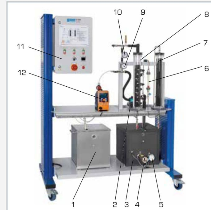
1 Behälter Adsorptiv-Lösung, 2 Zirkulationspumpe, 3 Reinwasserbehälter, 4 Heizer, 5 Temperaturempfänger, 6 Durchflussmesser, 7 Sicherheitsadsorber, 8 Adsorber, 9 Thermometer, 10 Manometer, 11 Schaltschrank, 12 Dosierpumpe
