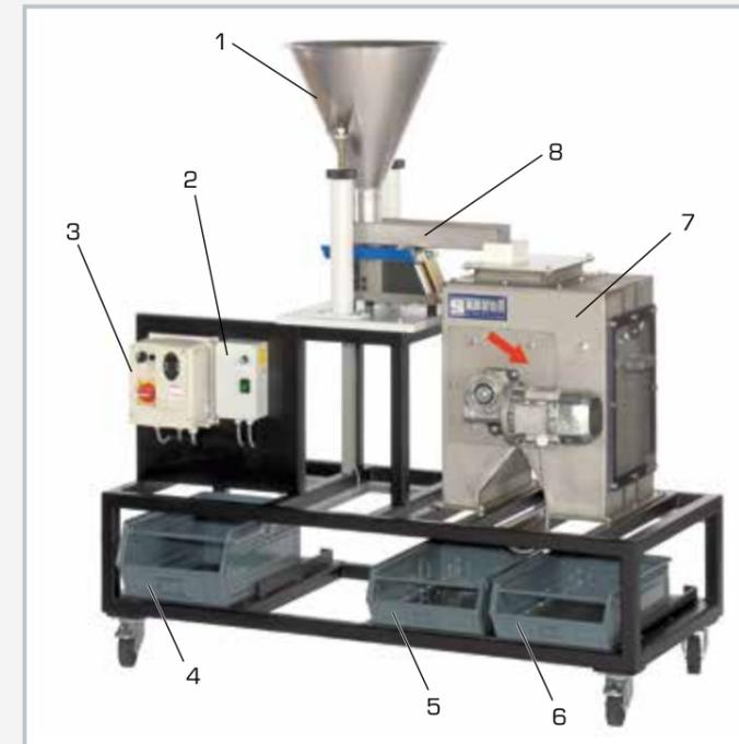
1 Aufgabetrichter mit Höhenverstellung, 2 Bedienelemente Vibrationsrinne, 3 Bedienelemente Magnetscheider, 4 Behälter für Feststoffmischung, 5 Behälter magnetische Stoffe, 6 Behälter unmagnetische Stoffe, 7 Magnetscheider, 8 Vibrationsrinne
