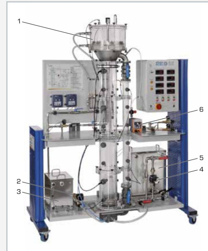
1 Airlift-Reaktor mit externem Umlauf, 2 Zulaufpumpe, 3 Zulaufbehälter, 4 Umrölpumpe, 5 Speicherbehälter, 6 Dosierpumpe
