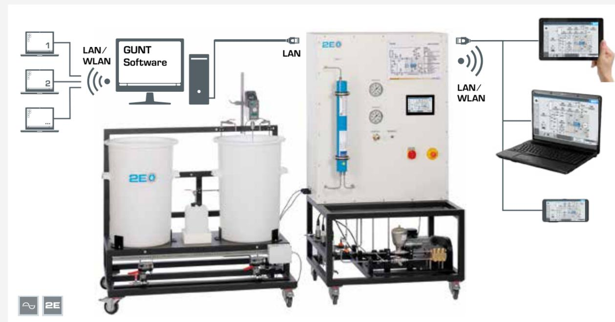
Die Abbildung zeigt: Versorgungseinheit (links) und Versuchsstand (rechts), Screen-Mirroring ist an verschiedenen Endgeräten möglich
