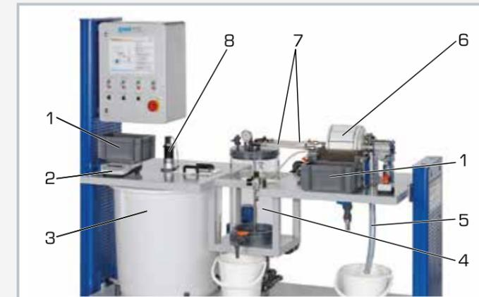
1 Auffangbehälter Filterkuchen, 2 Waage, 3 Suspensionsvorratsbehälter, 4 Vakuumbehälter Filtrat, 5 Überlauf/Ablauf, 6 Trommelzellenfilter, 7 Vakuumsversorgung, 8 Rührwerk
