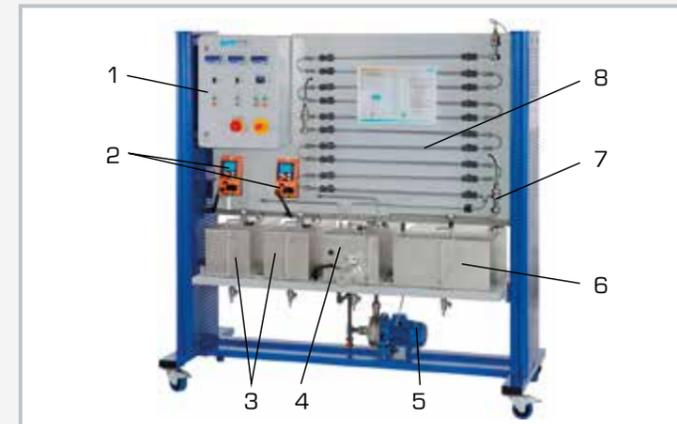
1 Schaltschrank, 2 Eduktpumpen mit Volumenstrommessung, 3 Eduktbehälter, 4 Warmwasserbehälter, 5 Pumpe, 6 Produktbehälter, 7 Messung von Temperatur und elektrischer Leitfähigkeit, 8 Strömungsrohrreaktor mit 10 Abschnitten
