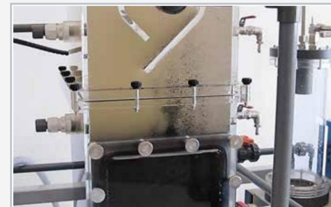
UASB-Reaktor im Versuchsbetrieb
