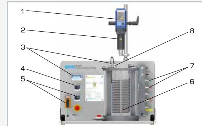
1 Rührwerk, 2 Drehmomentmessung, 3 elektrische Leitfähigkeitsmessung, 4 Temperatureinstellung, 5 Durchflusseinstellung für Gas, 6 Rohrschlange, 7 Anschlüsse für Warm- und Kaltwasser sowie Gas, 8 freie Anschlüsse für weitere Messinstrumente
