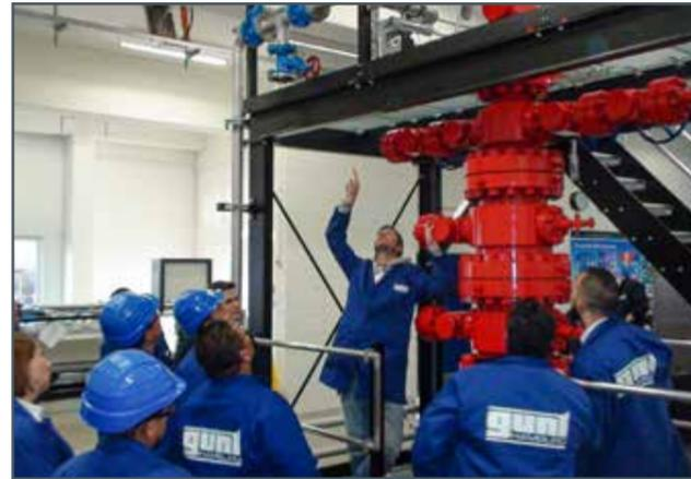
Montage bzw. Demontage des Bohrlochkopfes und des Eruptionskreuzes (X-mas tree)
