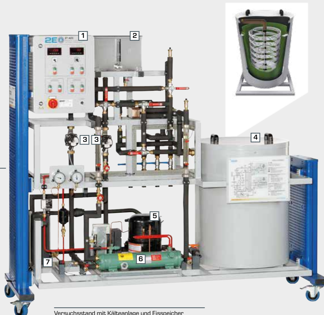
Versuchsstand mit Kälteanlage und Eisspeicher
