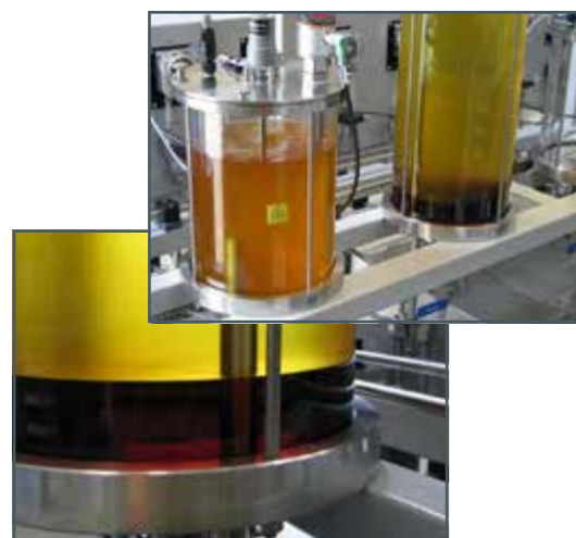
Transparente Behälter ermöglichen die kontinuierliche Beobachtung von Reaktionen und Trennvorgängen.
