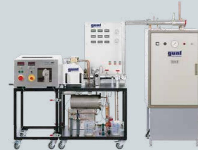
Installation d'essai avec machine à vapeur à deux cylindres ET 813, générateur de vapeur ET 813.01 et unité de freinage HM 365
