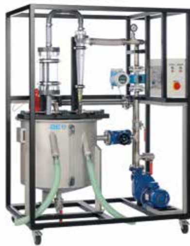
CE 225 Hydrocyclone Séparation des matières solides dans les liquides par la force centrifuge
