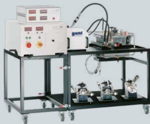
Banc d'essai pour pompes volumétriques avec unité de base HM 365.20, pompe à vis HM 365.21 et unité d'entraînement HM 365.
