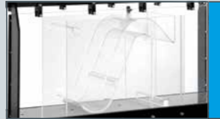
HM 162.36 Déversoir à siphon
