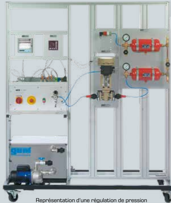
Représentation d'une régulation de pression entièrement montée après planification et exécution de la tuyauterie et du câblage.
