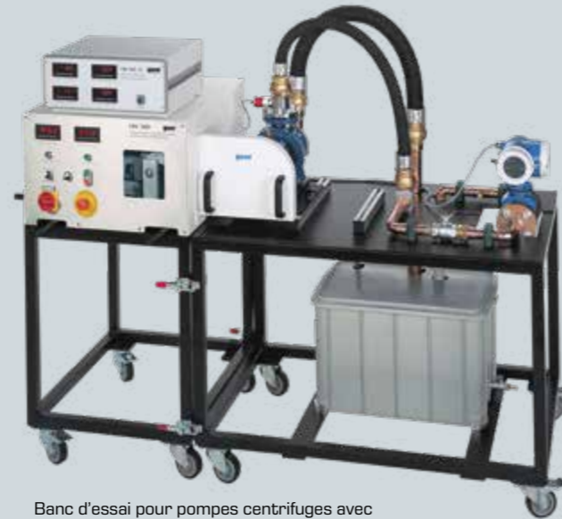
Banc d'essai pour pompes centrifuges avec unité de base HM 365.10, pompe centrifuge HM 365.11 et unité d'entraînement HM 365.
