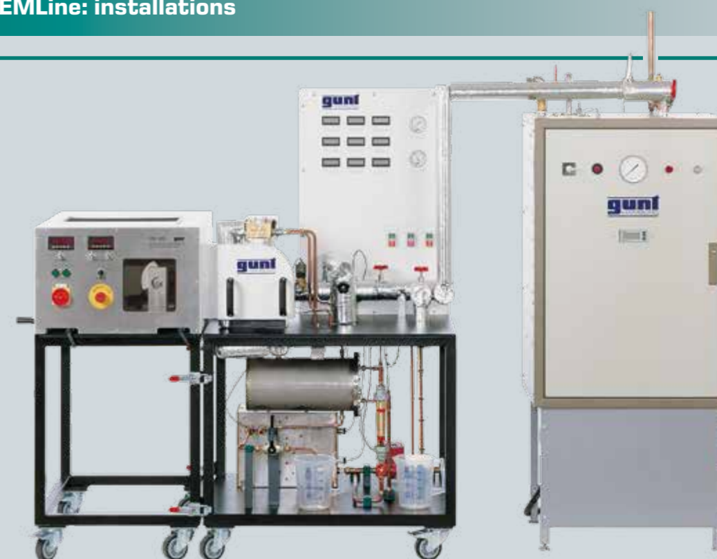
Installation d'essai avec machine à vapeur à deux cylindres ET 813, générateur de vapeur ET 813.01 et unité de freinage HM 365
