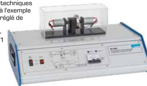
RT 050 Système d'exercice régulation de vitesse de rotation, HSI
