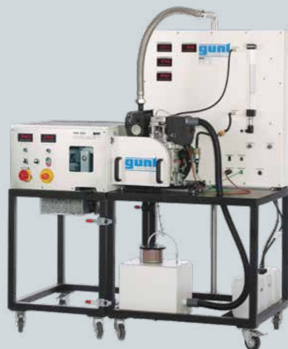
Banc d'essai modulaire pour moteurs monocylindres CT 159, avec moteur CT 151 et unité de freinage HM 365
