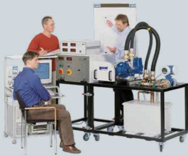
Banc d'essai pour pompes volumétriques avec unité de base HM 365.10, pompe à piston HM 365.17 et unité d'entraînement HM 365.
