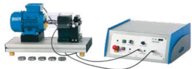
PT 501 Schäden bei Wälzlagern
