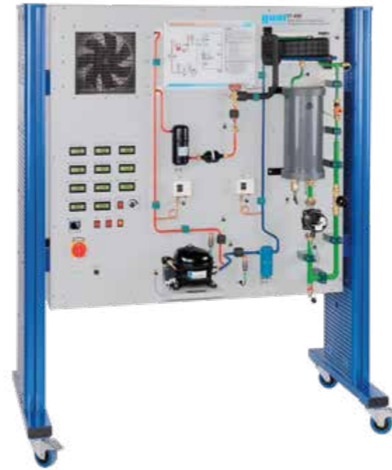
ET 120 Kühlung mit Hilfe des Peltiereffekts Demonstration des thermo- elektrischen Effekts
