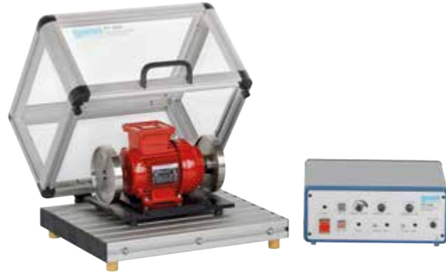
PT 502 Betriebsauswuchten Messung von Unwuchtschwingungen
