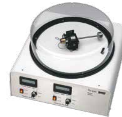
TM 630 Gyroskop Experimentelle Überprüfung der Kreiselgesetze
