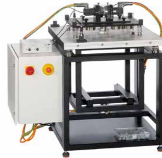
TM 182 Schwingungen an Maschinenfundamenten Fundamentierung von Maschinen und Isolierung von Schwingungen
