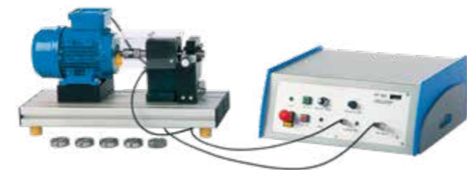
PT 501 Schäden bei Wälzlagern
