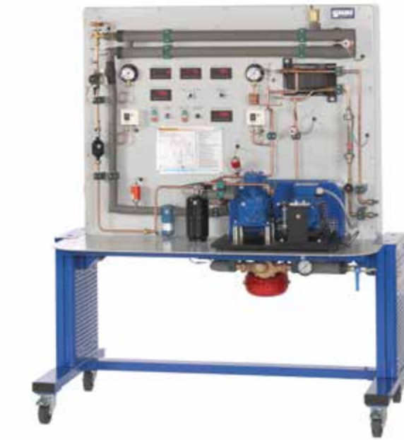
ET 351C Thermodynamik des Kältekreislaufs Kompressionskälteanlage für thermodynamische Untersuchungen; Messung der mechanischen Verdichterleistung
