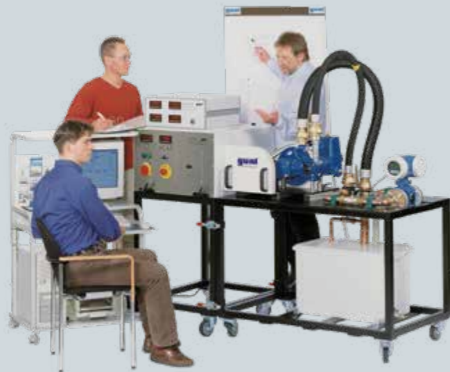
Versuchsstand für Verdrängerpumpen mit Basiseinheit HM 365.10, Kolbenpumpe HM 365.17 und Antriebseinheit HM 365.
