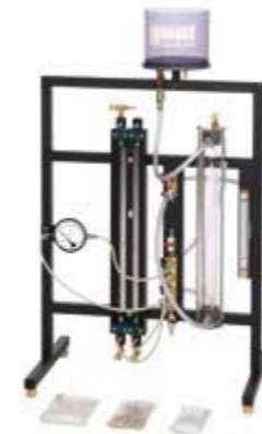
CE 117 Durchströmung von Partikelschichten Untersuchung der Eigenschaften von flüssigkeitsdurchströmten Schütt- und Wirbelschichten
