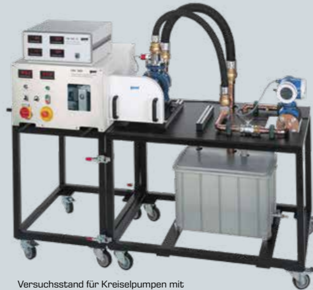
Versuchsstand für Kreiselpumpen mit Basiseinheit HM 365.10, Kreiselpumpe HM 365.11 und Antriebseinheit HM 365.
