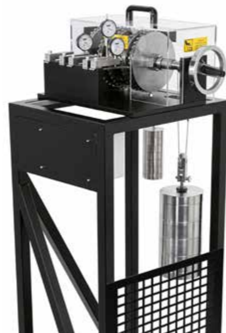
GL 212 Dynamisches Verhalten mehrstufiger Planetengetriebe Dynamische Untersuchung eines zweistufigen Getriebes mit je drei Planetenrädern; vier verschiedene Übersetzungen einstellbar
