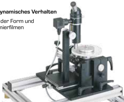
TM 260.04 Reibschwingungen Unterschiede von Haft- und Gleitreibung, Instabilität
