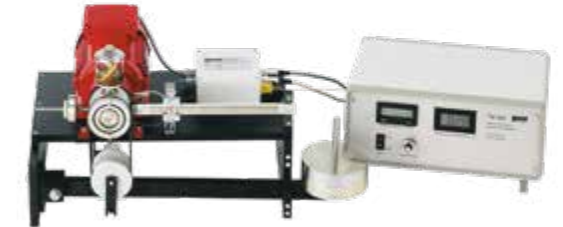
TM 282 Reibung in Gleitlagern Grundlagen der hydrodynamischen Schmierung im Versuch erarbeiten
