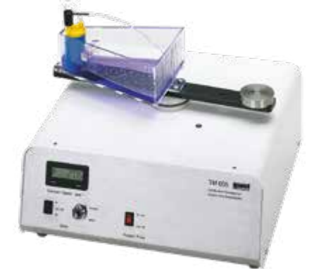
TM 605 Corioliskraft Scheinkräfte in einem rotierenden Bezugssystem
