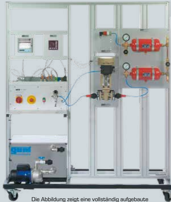
Die Abbildung zeigt eine vollständig aufgebaute Druckregelung nach Planung und Ausführung der Verrohrung und Verkabelung.
