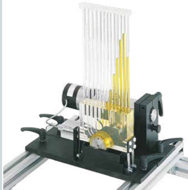
TM 260.06 Druckverteilung in Gleitlagern Demonstration der Druckverteilung bei hydrodynamischer Schmierung
