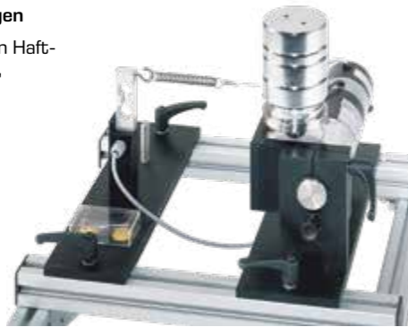
TM 260.05 Gleitreibung bei zylindrischem Stift – Walze Verschleißuntersuchung bei Reibpaarungen mit Punktberührung
