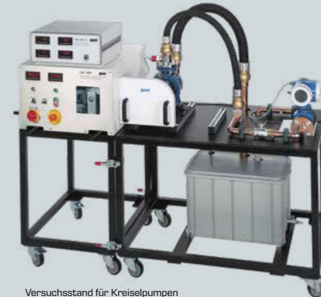
Versuchsstand für Kreispumpen mit Basiseinheit HM 365.10, Kreispumpe HM 365.11 und Antriebseinheit HM 365.
