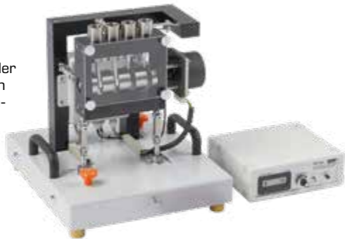
GL 112 Untersuchung von Kurvengetrieben Vergleich verschiedener Kurvenglieder; Aufzeichnung von Erhebungskurven
