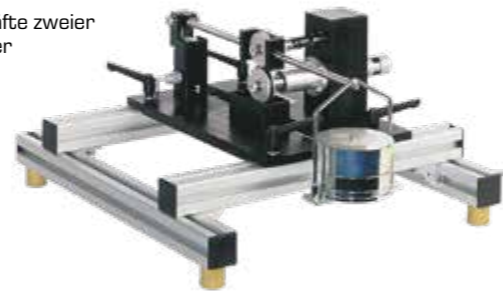
TM 260.03 Gleitreibung bei Stift – Scheibe Verschleißuntersuchungen bei Reibpaarungen mit Flächenberührung
