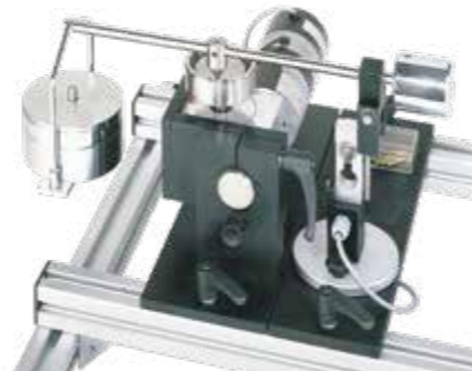
TM 260.06 Druckverteilung in Gleitlagern Demonstration der Druckverteilung bei hydrodynamischer Schmierung
