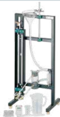
CE 116 Kuchen- und Tiefenfiltration Grundlagen der Filtration: Gleichung von Darcy
