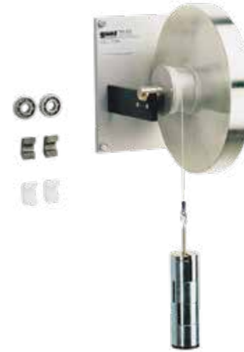
TM 232 Reibung in Lagern Gleitlagerreibung bei unterschiedlichen Lagerwerkstoffen, Vergleich mit Wälzlagerreibung
