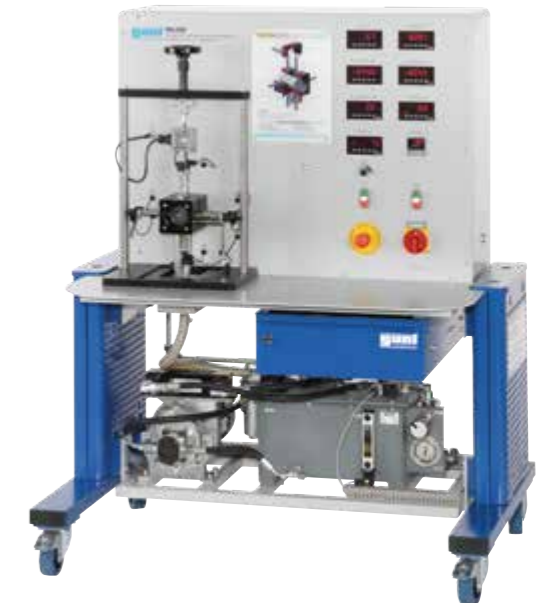
TM 290 Gleitlager mit hydrodynamischer Schmierung Einfluss von Drehzahl, Lagerpiel und Lagerlast auf die Verschiebung des Lagerzapfens; Wellenzapfen mit unterschiedlichen Durchmessern
