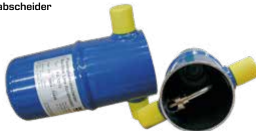
ET 499.14 Schnittmodell Flüssigkeitsabscheider
