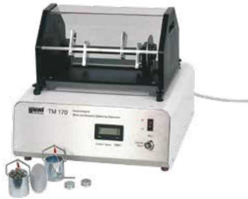
TM 170 Auswuchtgerät Statische, dynamische und allgemeine Unwucht an einer Welle
