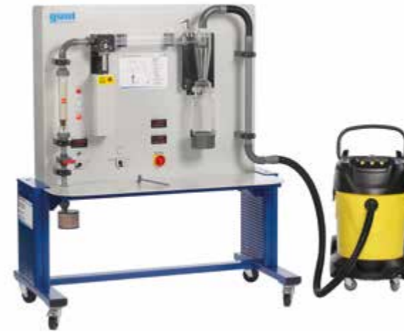
CE 235 Gaszyklon Feststoffabscheidung aus Gasen mit einem Zyklon
