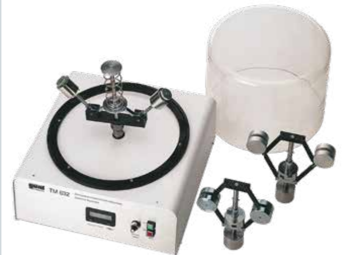
TM 632 Fliehkraftregler Kennlinien und Einstellkurven unterschiedlicher Fliehkraftregler
