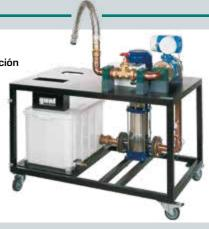
Banco de ensayos para turbinas con la unidad básica HM 365.32, turbina Pelton HM 365.31 y unidad de frenado HM 365
