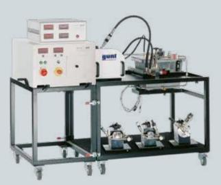
Banco de ensayos para bombas de desplazamiento positivo con la unidad básica HM 365.20, bomba de husillo HM 365.21 y unidad de accionamiento HM 365.
