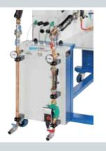
Compresor de chorro de vapor en la refrigeración
