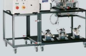
Banco de ensayos para bombas de desplazamiento positivo con la unidad básica HM 365.20, bomba de husillo HM 365.21 y unidad de accionamiento HM 365.
