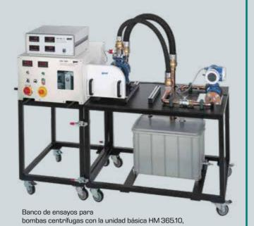
bomba centrífuga HM 365.11 y unidad de accionamiento HM 365.
