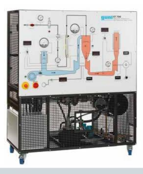
Turbina de gas como motor a reacción
