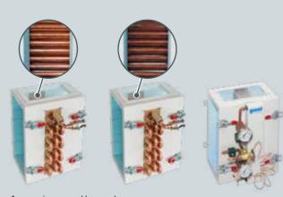
Accesorios para el banco de ensayos: WL 312.01 Transferencia de calor en los tubos lisos,
