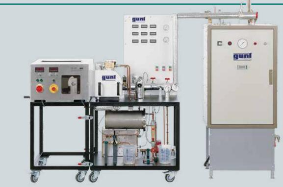
Planta de ensayo con máquina de vapor de dos cilindros ET 813, generador de vapor ET 813.01 y unidad de frenado HM 365
