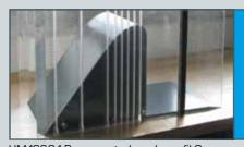
HM 162.34 Presa-vertedero de perfil Ogee con medición de la presión
