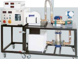
Banco de ensayos para turbinas con la unidad básica HM 365.32, turbina Pelton HM 365.31 y unidad de frenado HM 365
