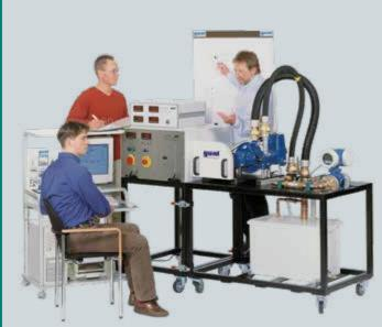
Banco de ensayos para bombas de desplazamiento positivo con la unidad básica HM 365.10, bomba de émbolo HM 365.17 y unidad de accionamiento HM 365.
