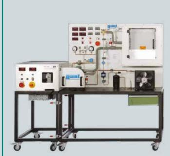
Instalación frigorífica de compresión ET 165 con unidad de accionamiento HM 365
