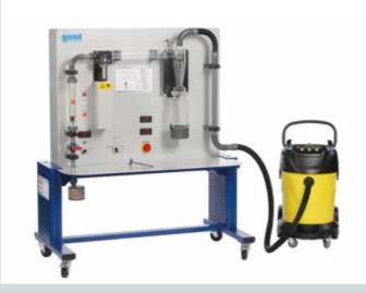
Ingeniería de las operaciones básicas mecánicas **Métodos de separación: filtración**
