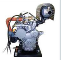
Unidad de carga, 75kW para motores de cuatro cilindros
