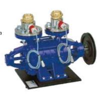
HM 365.14 Bombas centrífugas, conexión en serie y en paralelo
