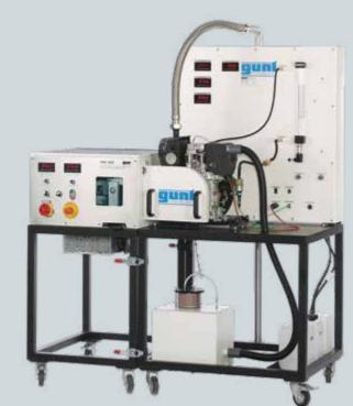
Banco de ensayos modular para motores de un cilindro con CT 159, motor de prueba CT 151 y unidad de frenado HM 365
