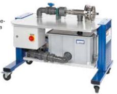
Planta de ensayo de turbomáquinas axiales
