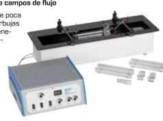
Túnel de viento para la visualización de líneas de corriente
