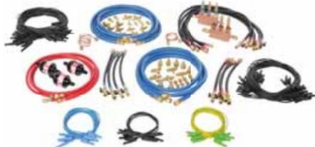
Der Zubehörsatz ET 910.12 wird zur hydraulischen und elektrischen Verbindung der Komponenten miteinander und mit der Basiseinheit benötigt. Er beinhaltet Kältemittelschläuche in unterschiedlichen Längen und Durchmessern (z. T. mit Absperrhähnen), Kältemittel-Filter/Trockner als Ersatz, T-Stücke, Kupplungsstücke und Laborkabel. Weiterhin sind zwei unterschiedlich lange Kapillarrohre, zwei Verteiler und eine ausreichende Länge an Isolierschlauch enthalten.
