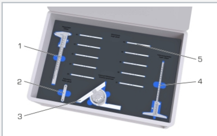
1 pied à coulisse, 2 jauge de rayon, 3 goniomètre universel, 4 pied à coulisse de profondeur, 5 objet de contrôle (pièce angulaire)
