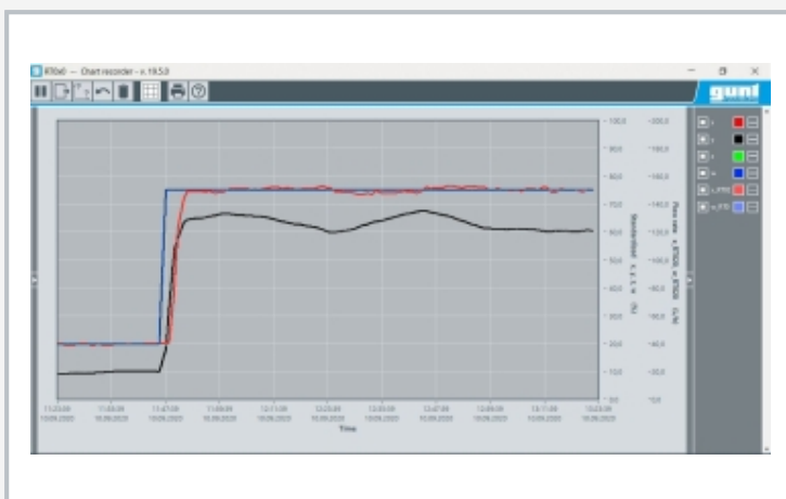
Screenshot der Software: Durchflussregelung mit PI-Regler, Führungsgrößen sprung
