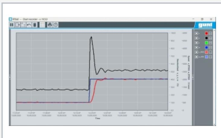
Captura de pantalla del software: regulación de número de revoluciones con regulador PID, escalón en la variable de referencia, sin variable de perturbación
