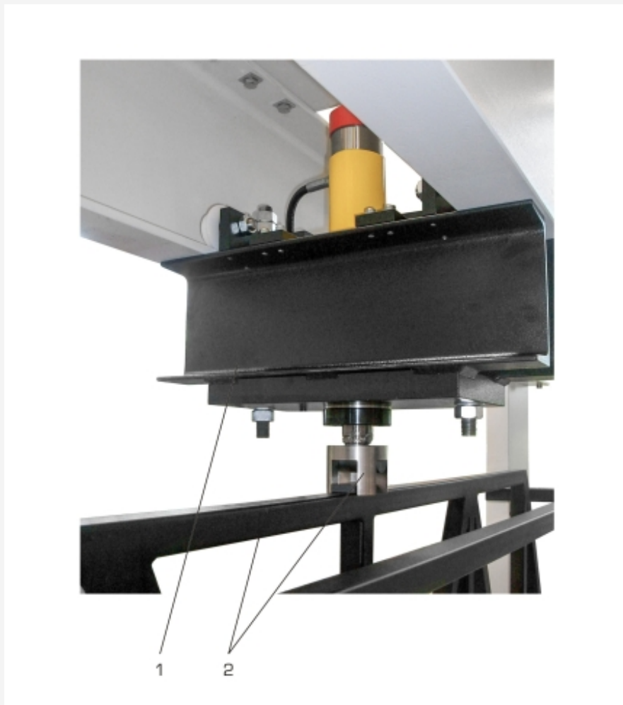
1 dispositivo de carga con cilindro de prensa, 2 celosía con empujador de carga SE 100.04
