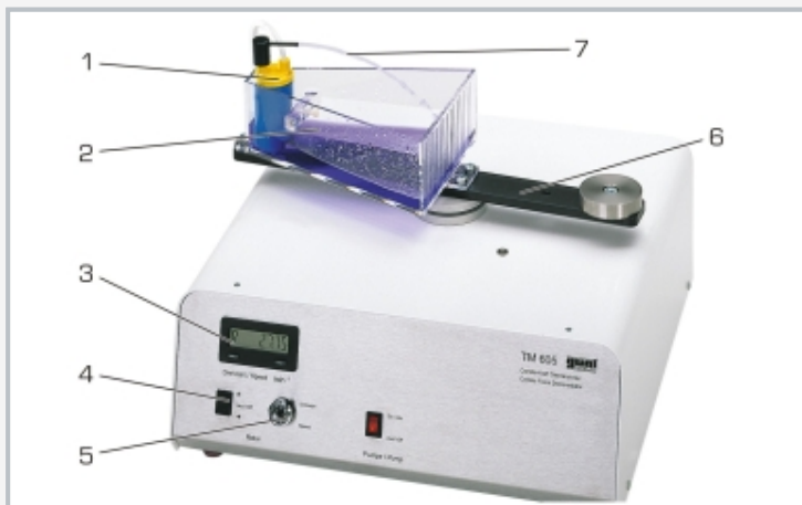
1 Pumpe, 2 Wasserbehälter, 3 Anzeige der Drehzahl, 4 Schalter für Drehrichtung, 5 Drehzahleinstellung, 6 drehbarer Ausleger, 7 Wasserstrahl
