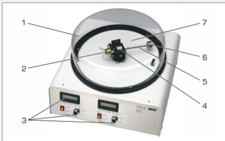
1 cubierta protectora, 2 motor de accionamiento del giroscopio, 3 indicación y ajuste del número de revoluciones para el eje horizontal del giroscopio y el eje vertical de precesión, 4 peso oscilante giroscopio, 5 palanca, 6 peso móvil, 7 bastidor interno
