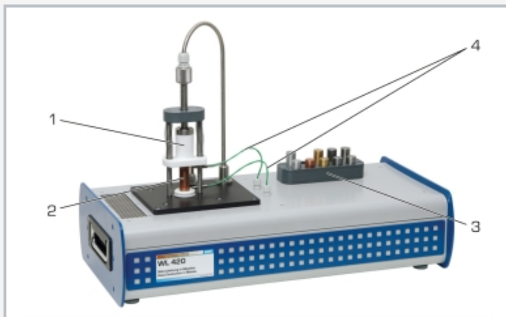
1 dispositivo de calefacción, 2 probeta, 3 repisa para probetas, 4 termopar; elemento Peltier cubierto
