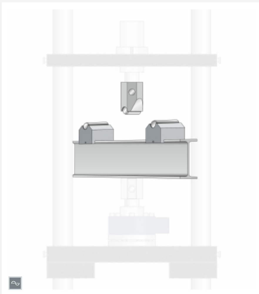
Die Abbildung zeigt das Zubehör WP 310.03 eingebaut in den Arbeitsbereich von WP 310.
