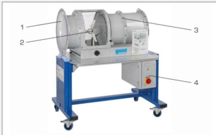
1 Einlaufkontur, 2 Versuchsstrecke, 3 Windkanal, 4 Schaltkasten
