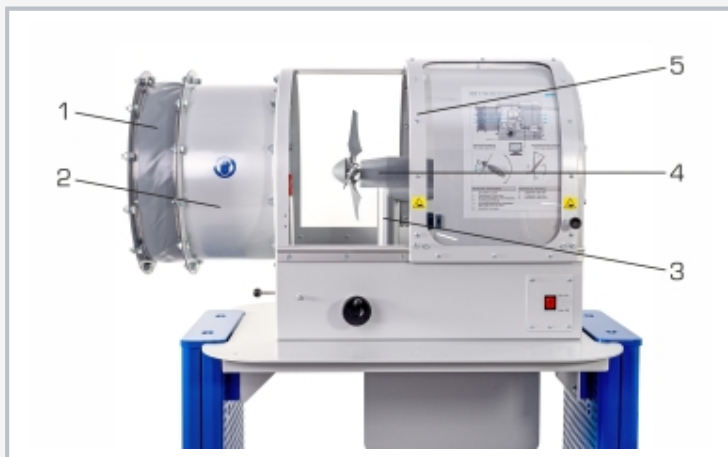
1 Anschluss für Windkanal HM 170, 2 Strömungsgleichrichter, 3 Turm, 4 Windkraftanlage, 5 Schutzhaube
