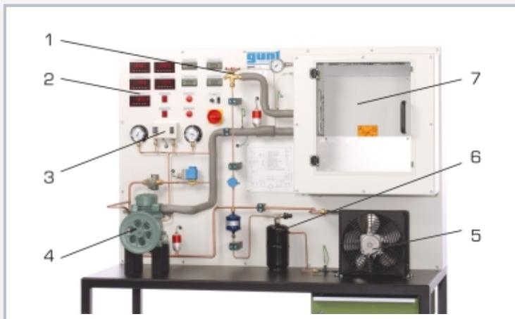
1 soupape de détente, 2 éléments d'affichage et de commande, 3 pressostat, 4 compresseur, 5 condenseur, 6 réservoir, 7 chambre de refroidissement
