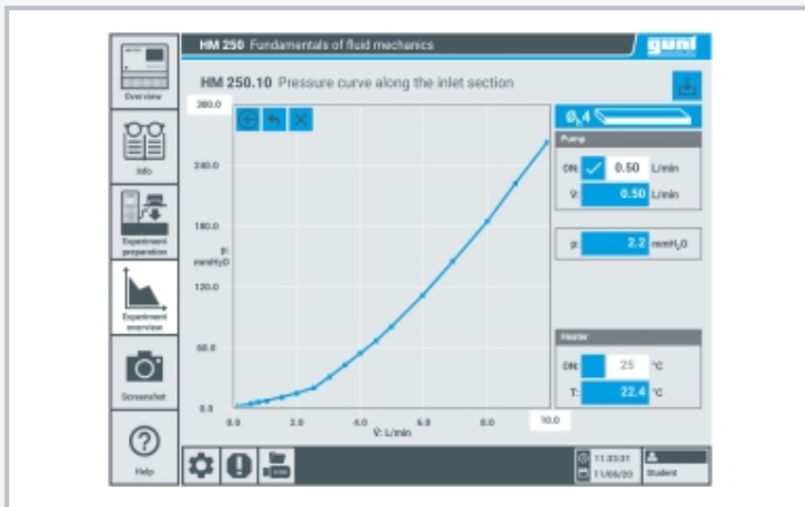
Intuitive Bedienoberfläche im Touchscreen von HM 250: Druckmessung in der Rohrstrecke (Rechteckquerschnitt) und graphische Darstellung der Messwerte, Druckverlauf im ausgebildeten Strömungsbereich
