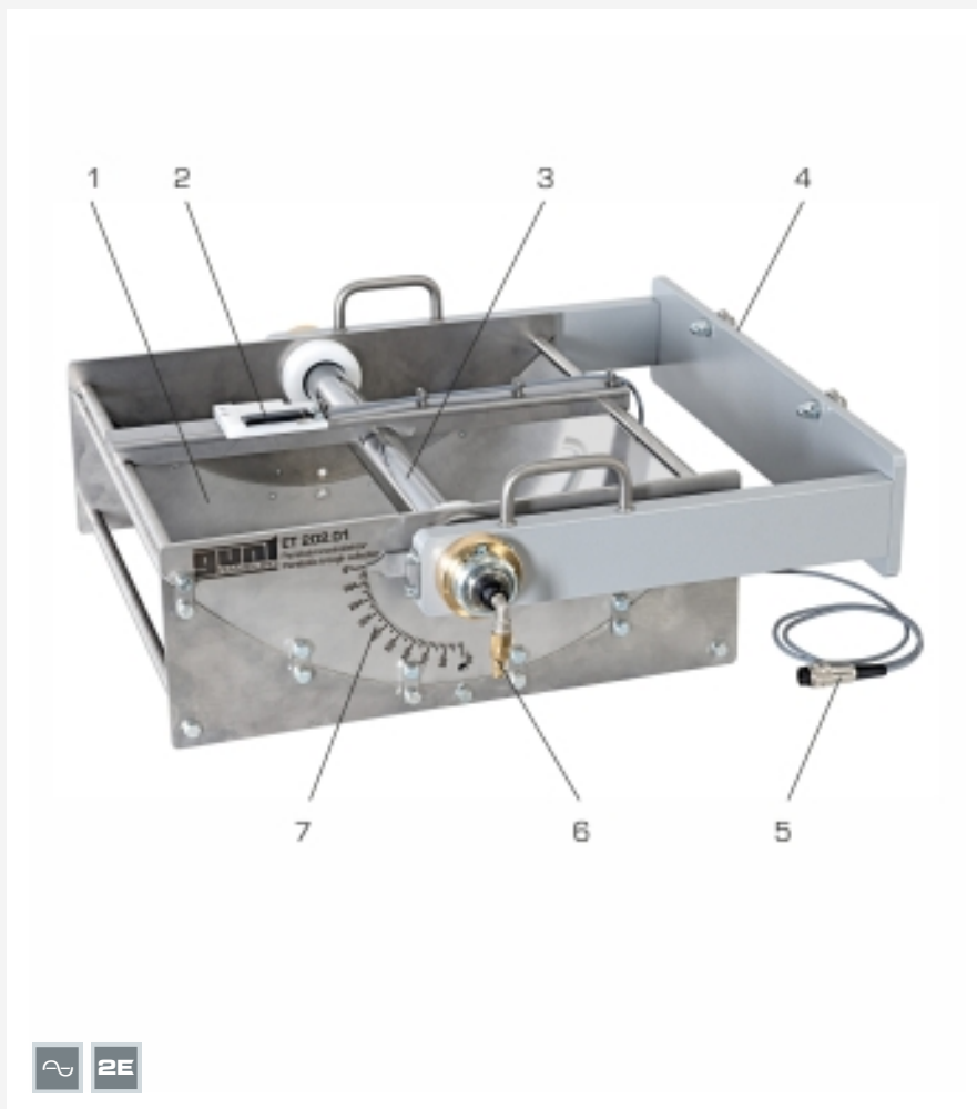
1 miroir cylindro-parabolique, 2 capteur l'éclairement (contenu de la livraison de l'ET 202), 3 tube absorbeur, 4 suspension, 5 câble et connexion du capteur (contenu de la livraison de l'ET 202), 6 connexion au circuit solaire de l'ET 202, 7 échelle
