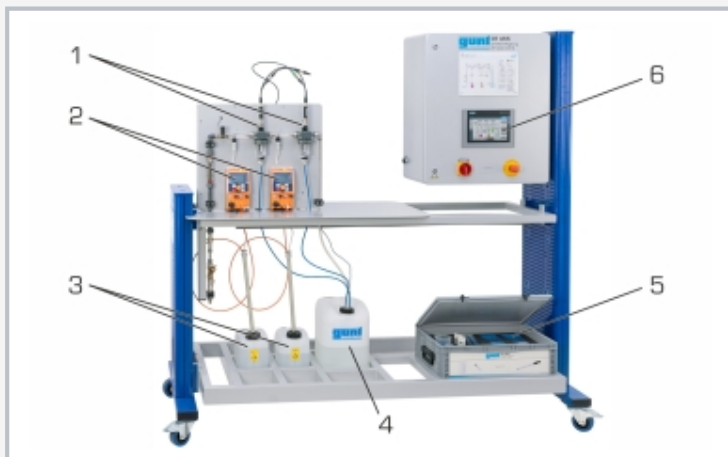
1 sensores de pH inteligentes, 2 bombas dosificadoras, 3 depósito de sustancias químicas, 4 depósito del producto, 5 accesorios, 6 pantalla táctil
