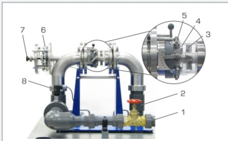
1 alimentación de agua de HM 450C, 2 desagüe de agua al HM 450C, 3 rotor, 4 ajuste de los álabes distribuidores, 5 puntero con escala de la posición de los álabes distribuidores, 6 freno de corrientes parásitas, 7 volante de mano para ajustar el freno, 8 sensor de presión
