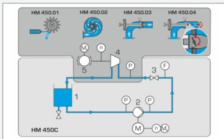
1 depósito, 2 bomba, 3 válvula de estrangulación, 4 turbina, 5 freno, M motor; F caudal, P presión, n número de revoluciones,  $M_d$  par
