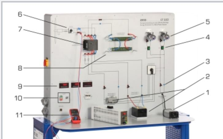
1 Wechselrichter, 2 Akkumulatoren, 3 Messpunkt Strom und Spannung, 4 Schalter für elektrische Last, 5 Lampen als Verbraucher, 6 Bremsschalter Windkraftanlage, 7 Laderegler, 8 Lastwiderstände, 9 Anzeigen für Windgeschwindigkeiten und Drehzahl, 10 Bedienelemente für Axialgebläse, 11 Multimeter
