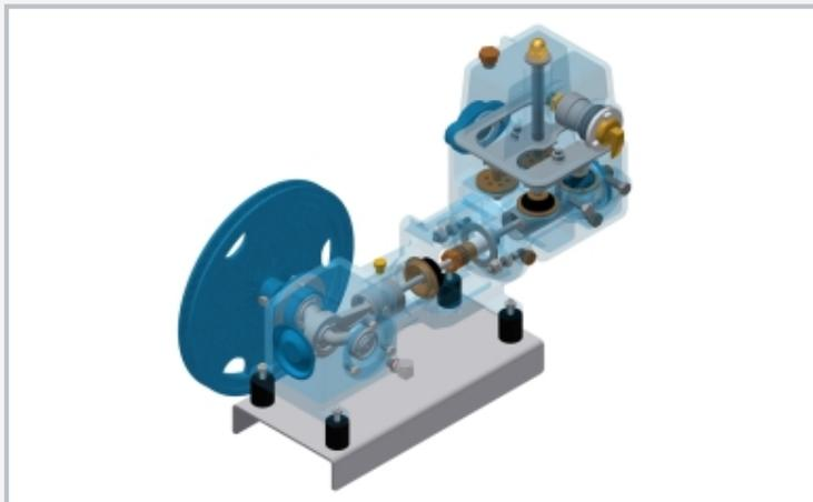
Dibujo seccional transparente de la bomba de émbolo montada
