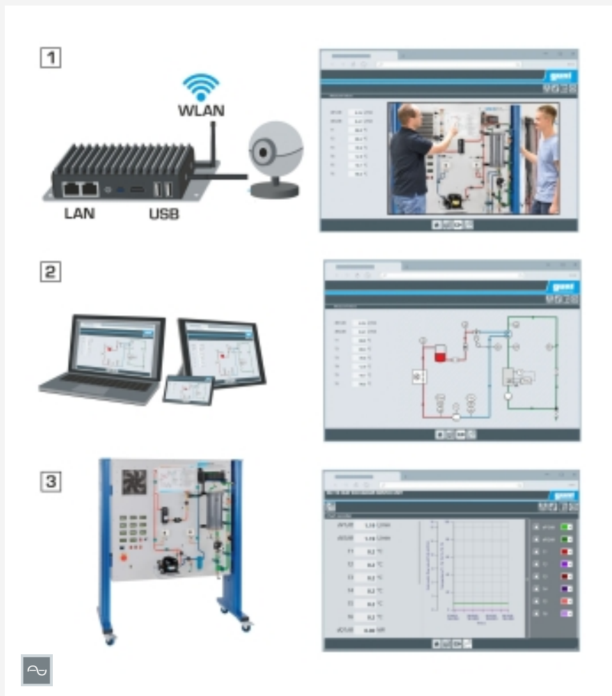
Ejemplo de montaje experimental: 1 GU 100 Web Access Box con transmisión de imágenes en directo, 2 varios dispositivos finales con acceso al software a través del navegador web, 3 equipo de ensayo con adquisición de datos
