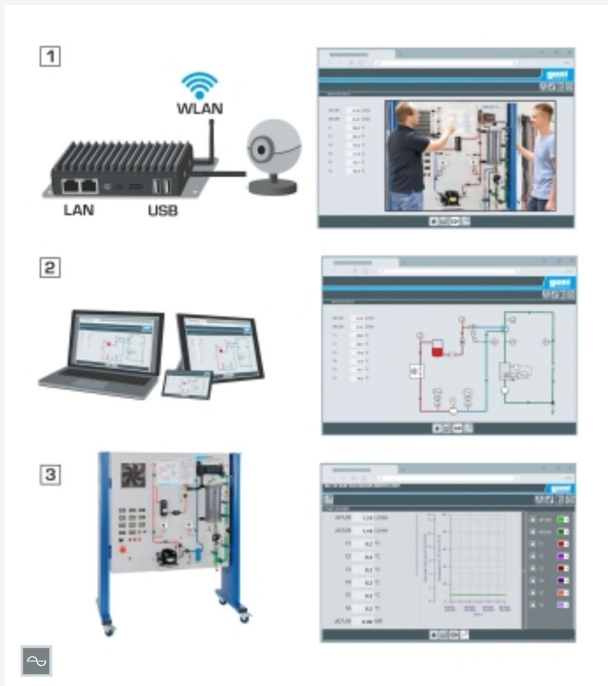
Ejemplo de montaje experimental: 1 GU 100 Web Access Box con transmisión de imágenes en directo, 2 varios dispositivos finales con acceso al software a través del navegador web, 3 equipo de ensayo con adquisición de datos
