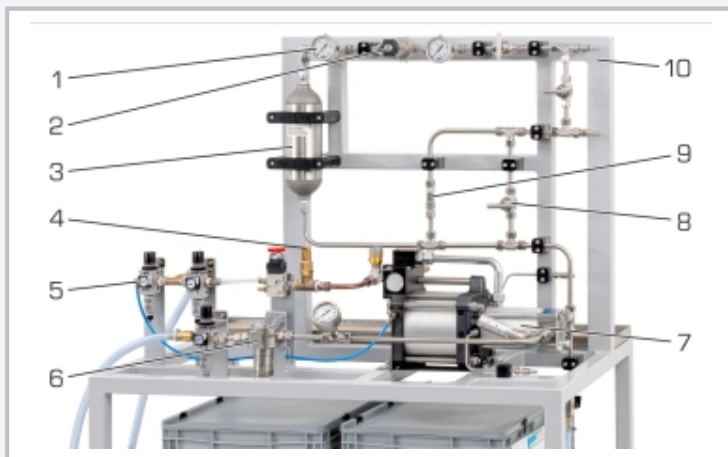
1 Manometer, 2 Druckregler, 3 Druckbehälter, 4 Sicherheitsventil, 5 Wartungs- und Druckregleinheit für Druckluft, 6 Filter, 7 Gasbooster, 8 Absperrventil, 9 Berstscheibe, 10 Druckluftaustritt Rohrstrecke
