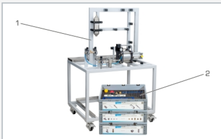
1 structure de base avec booster de gaz prémonté, réservoir sous pression et raccords d'air comprimé du laboratoire, 2 système de rangement avec éléments, outil, pièces détachées
