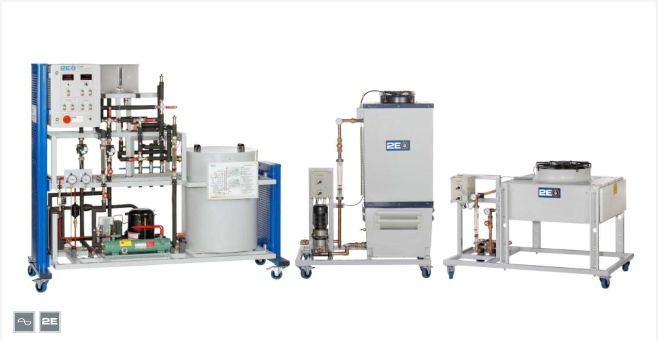
Die Abbildung zeigt den Versuchsstand links, Nasskühlturm in der Mitte und Trockenkühlturm rechts.
