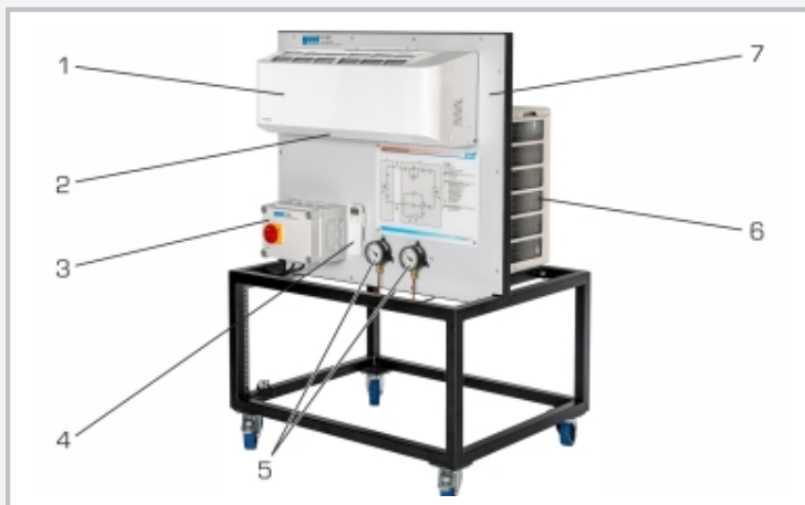
1 unité interne, 2 sortie d'air de l'unité interne, 3 armoire de commande, 4 commande à distance, 5 manomètre, 6 unité externe, 7 cloison
