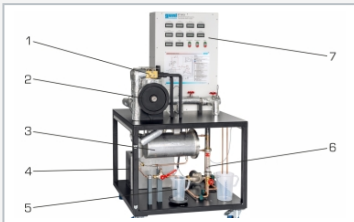
1 machine à vapeur, 2 courroie de transmission au HM 365, 3 condenseur, 4 réservoir de condensat, 5 récipient gradué, 6 capteur de débit d'eau de refroidissement, 7 éléments d'affichage et de commande
