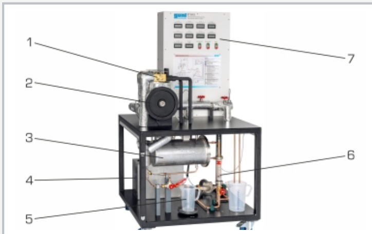
1 Dampfmaschine, 2 Riementrieb zu HM 365, 3 Kondensator, 4 Kondensatbehälter, 5 Messbehälter Kondensat, 6 Aufnehmer Durchfluss Kühlwasser, 7 Anzeige- und Bedienelemente
