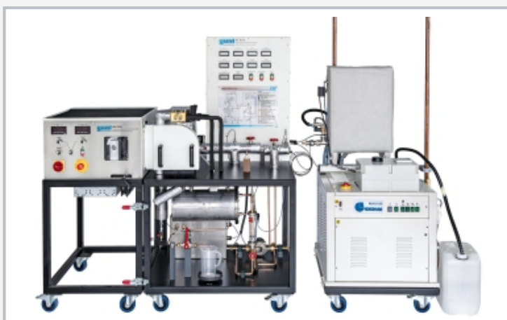
Betriebsbereiter Versuchsaufbau: links: Bremsseinheit: HM 365, Mitte: Zweizylinder-Dampfmaschine ET 813, rechts: Dampferzeuger ET 813.01
