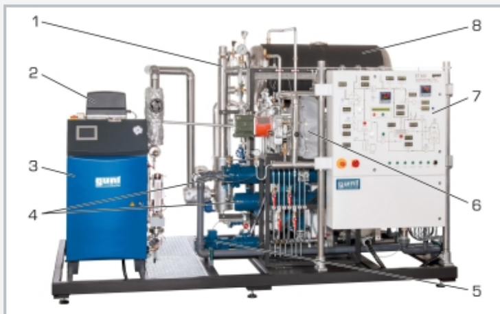
1 sobrecalentador, 2 quemador, 3 caldera, 4 condensador, 5 bomba de condensado, 6 turbina, 7 elementos de indicación y mando, 8 depósito de agua de alimentación con procesamiento de agua de alimentación
