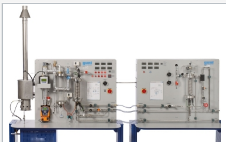
à gauche: le générateur de vapeur ET 850; à droite: la turbine axiale ET 851; en condition de fonctionnement, les deux appareils forment une centrale thermique à vapeur
