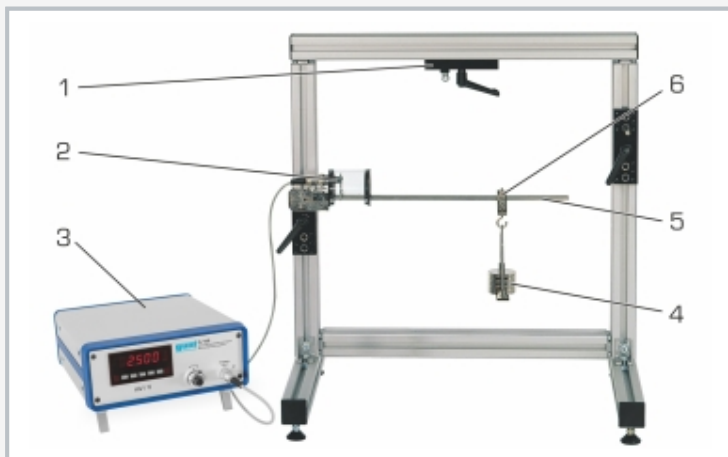
1 Halterung, 2 DMS-Messstelle, 3 Messverstärker, 4 Gewicht, 5 Biegebalken, 6 verschiebbarer Reiter
