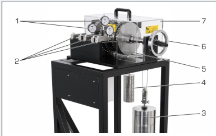
1 Messuhr, 2 Biegebalken, 3 Gewichtssatz, 4 Gewichtssatz zur Messung der Übersetzungsverhältnisse, 5 Planetengetriebe, 6 Handrad, 7 Schutzhaube
