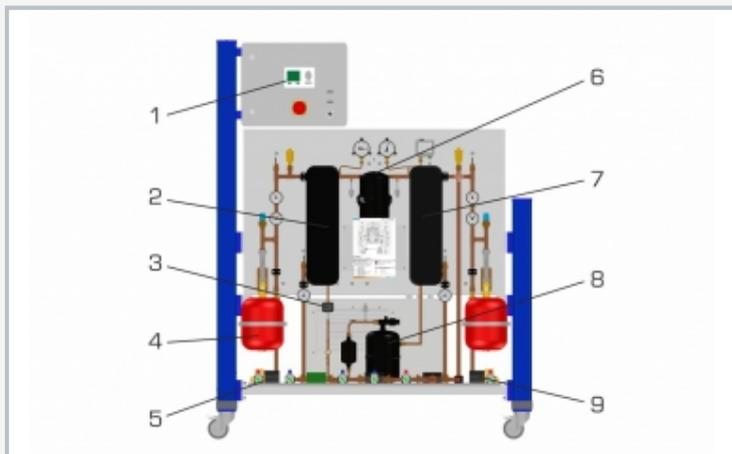
1 regulador de calefacción, 2 evaporador, 3 válvula de expansión, 4 depósito de expansión, 5 bomba circuito de fuente, 6 compresor scroll, 7 condensador, 8 recipiente, 9 bomba circuito de calefacción
