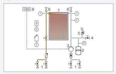
1 raccordements pour conduites de fluide caloporteur avec soupapes d'arrêt et accouplement rapide, 2 vase d'expansion à membrane, 3 pompe, 4 vanne de remplissage, 5 soupape de surpression, 6 purges d'air, 7 capteur à tubes sous vide, 8 bus de données CAN; E éclairement, F débit, T température, P pression
