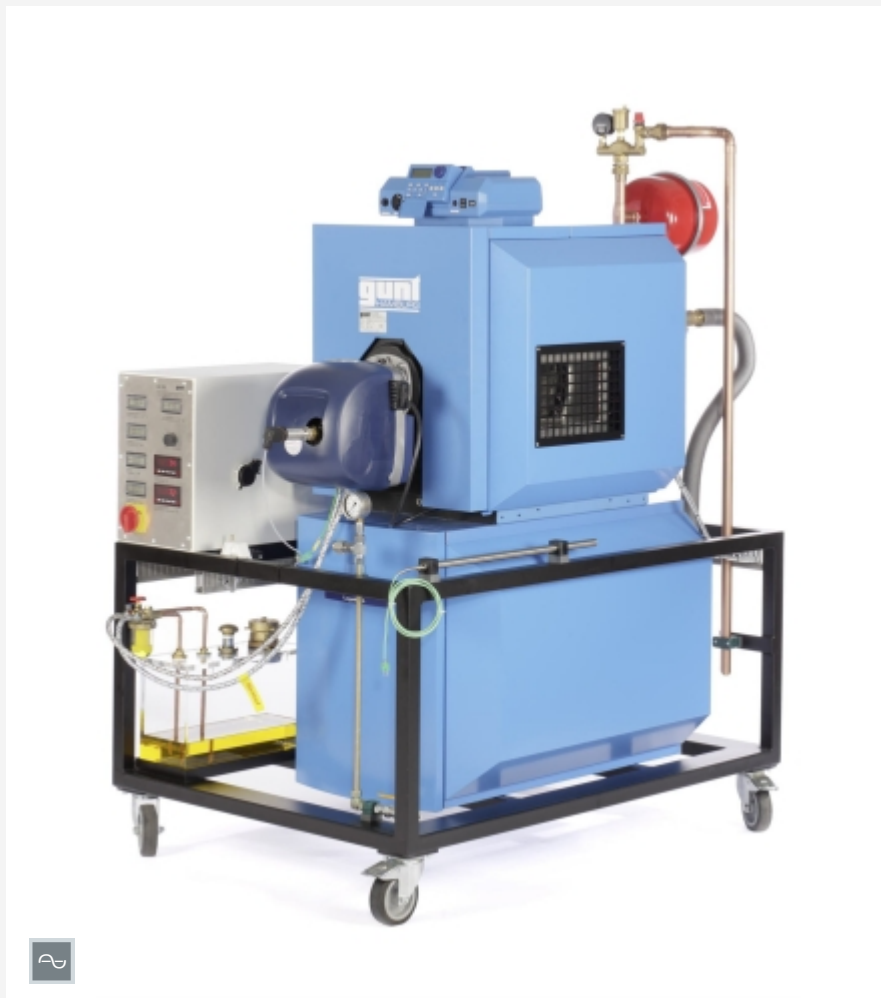
Die Abbildung zeigt den Versuchsstand zusammen mit dem Zubehör HL 352.01 Heizölbrenner
