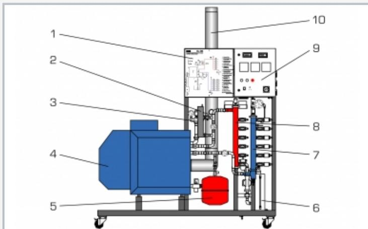
1 Prozessschema, 2 Wassermangelsicherung, 3 Kesselsicherheitsgruppe, 4 Heizkessel mit Ölbrenner, 5 Ausdehnungsgefäß, 6 Ölbehälter, 7 Heizungsrücklauf, 8 Heizungsvorlauf, 9 Schaltschrank mit Anzeige- und Bedienelementen, 10 Abgasrohr
