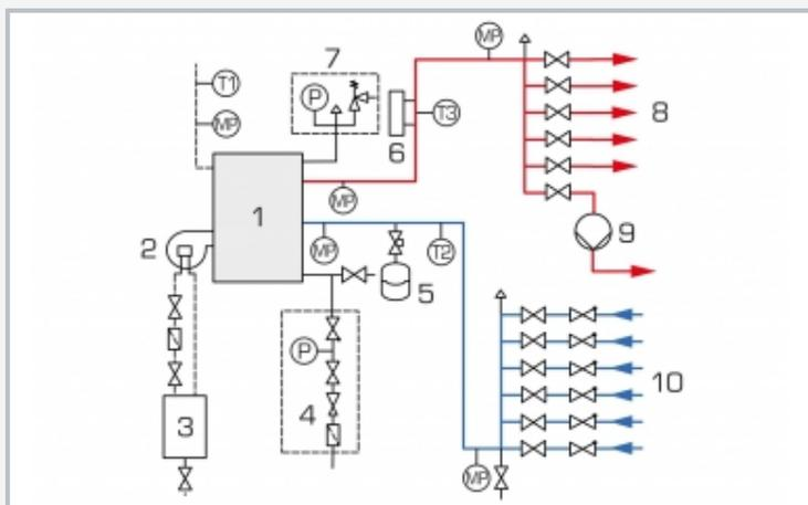
1 Heizkessel, 2 Brenner, 3 Ölbehälter, 4 Kesselfüllarmatur, 5 Ausdehnungsgefäß, 6 Wassermangelsicherung, 7 Kesselsicherheitsgruppe, 8 Verteiler Heizungsanlauf, 9 Umwälzpumpe (Heizungsanlauf), 10 Verteiler Heizungsrücklauf, T1-T3 Zeigerthermometer, MP Messpunkt für Druck oder Temperatur
