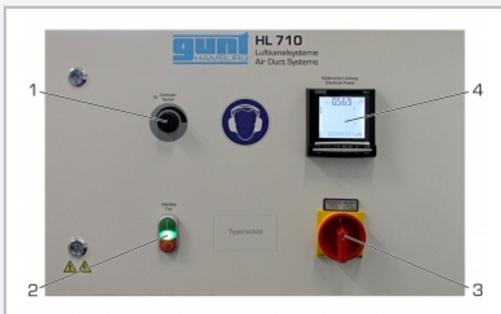
1 Einstellung Gebläsedrehzahl, 2 Schalter Gebläse, 3 Hauptschalter, 4 Leistungsmesser
