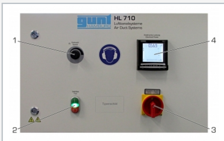
1 ajustage de la vitesse de rotation du ventilateur, 2 interrupteur MARCHE-ARRÊT du ventilateur, 3 interrupteur principal, 4 wattmètre
