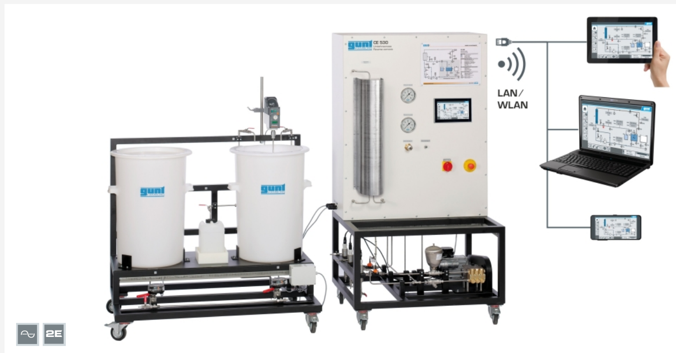
L'illustration montre: unité d'alimentation (à gauche) et banc d'essai (à droite), possibilité de "screen mirroring" sur différents terminaux
