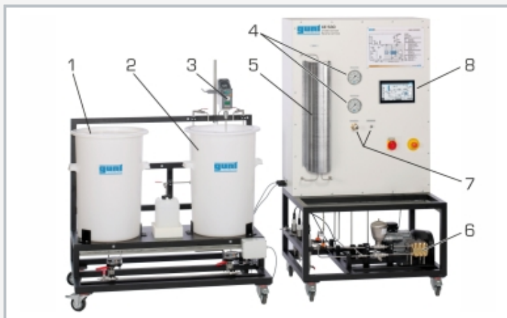
1 depósito de agua de lavado [agua destilada], 2 depósito de agua bruta (disolución salina), 3 mecanismo de agitación, 4 manómetros, 5 módulo de membrana en espiral, 6 bomba con motor, 7 válvulas, 8 PLC con pantalla táctil
