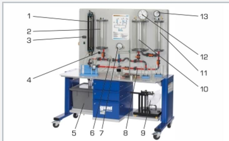
1 dos tubos manométricos, 2 depósito, 3 indicador de presión digital, 4 sensor de presión, 5 depósito de reserva con bomba sumergible, 6 tubo de Pitot y sonda para presión estática, 7 manómetro de presión diferencial, 8 sección de tubo, 9 presión hidrostática en líquidos, 10 depósito a presión, 11 depósito a presión, 12 manómetro de Bourdon, 13 manómetro de lámina elástica
