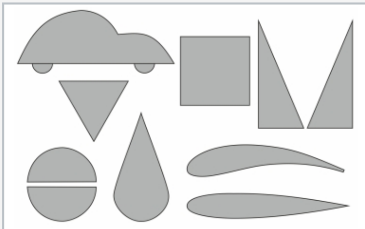
mitgelieferte Modelle Auto, Dreieck, Quadrat, 2 Dreiecke für Querschnittsänderung, 2 Halbkreise, Tropfen, Stromlinienkörper NACA 0015, Tragflächenprofil
